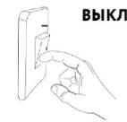
Перед выполнением каких-либо работ со светильником отключите питание и проверьте отсутствие напряжения в сети.
