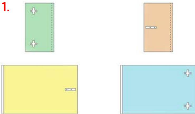
1. Avvitare con le viti in dotazione nei prefori le basette delle cerniere e il "Push" di apertura sulle spalle in base allo schema sotto riportato per decidere la tipologia di apertura desiderata
