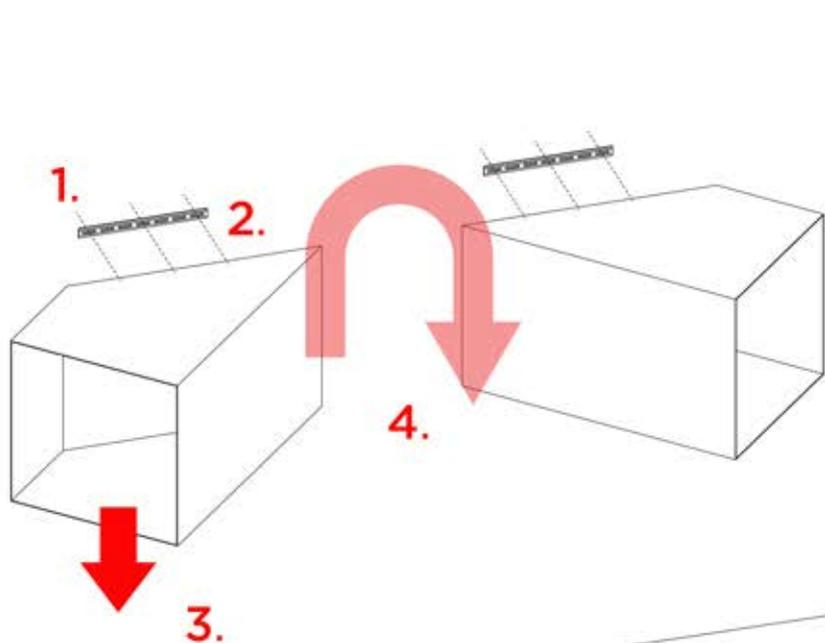
1. Mettere in bolla la barra di supporto nella posizione desiderata e segnare i punti di foratura per l'inserimento dei tasselli a muro
